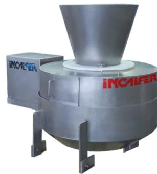
O Cortador de Batatas MCJ360 é um equipamento que foi desenvolvido para ser utilizado em grandes linhas de produção de batatas fritas, permitindo o corte de batata lisa, ondulada, palha ou palha extra fina.
